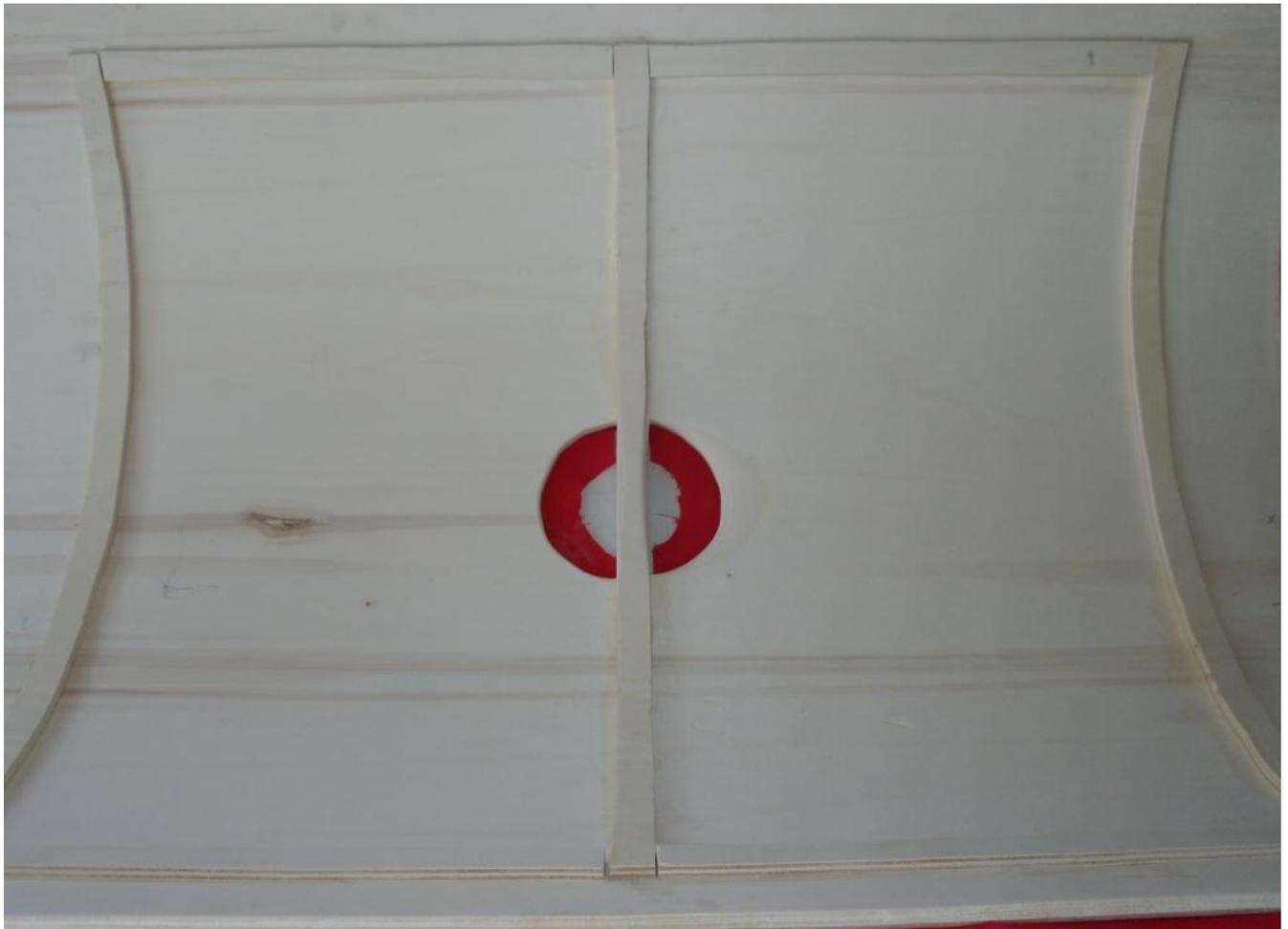
**Abb.6:** senkrechte Verstärkerleisten und geschliffener Griff
